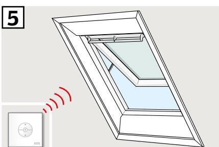
Ako se pokvareni zidni prekidač mora zamijeniti ili ako zidni prekidač ne može pronaći određene proizvode, proizvodi se mogu pripremiti za registraciju ručnim resetiranjem.
