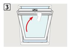
Quando la finestra è stata chiusa con la barra di manovra, si chiuderà completamente in modo automatico.
