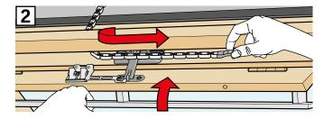
Una volta ripristinata la tensione di rete o ricaricata la batteria, la catena deve essere riagganciata.
