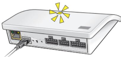
Verbinden Sie das Interface mit dem Netzanschluss. Wenn die Leuchtdiode gelb blinkt, ist das Interface zur Konfiguration bereit.
