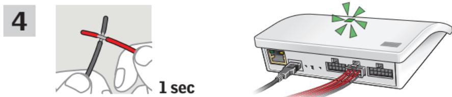
Drähte im doppelten Eingang, der das gewünschte Produkt bzw. Produkte ansteuern soll, kurzschließen (1 Sekunde). Die Leuchtdiode blinkt grün.
