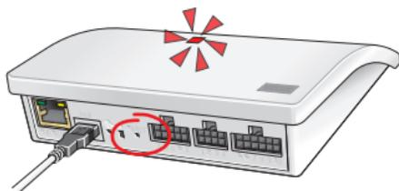
Drücken Sie die RESET-Taste auf der Rückseite des Interfaces 10 Sekunden mit einem spitzen Gegenstand, bis die Leuchtdiode rot leuchtet. Danach wird die Leuchtdiode gelb, gefolgt von einem roten Blitz.
