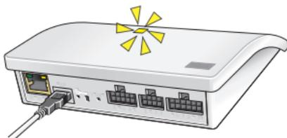
Verbinden Sie das Interface mit der Netzanschlussleitung. Wenn die Leuchtdiode gelb blinkt, ist das Interface zur Konfiguration bereit.
