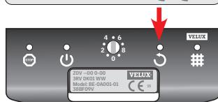
Nakon zamjene filtera pritisnite reset tipku kako biste resetirali ventilaciju s rekuperacijom.
