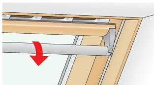
Quando apri l'aletta di ventilazione della finestra per tetti, automaticamente accendi il sistema di ventilazione. Quando chiudi l'aletta di ventilazione, spegni il sistema di ventilazione.
