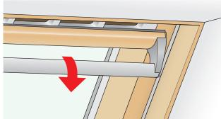
Ugrađeni ventilacijski sustav uključuje se automatski kada otvorite ventilacijski preklop krovnog prozora. Prilikom zatvaranja ventilacijskog preklopa ugrađeni ventilacijski sustav se isključuje.
