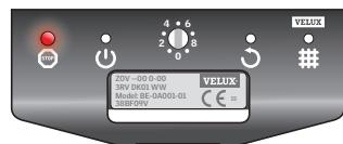
En cas d'erreurs dans le fonctionnement de l'unité de ventilation à récupération de chaleur, la diode lumineuse rouge est activée. Pour réinitialiser l'unité de ventilation, fermer puis rouvrir le clapet de ventilation de la fenêtre.
