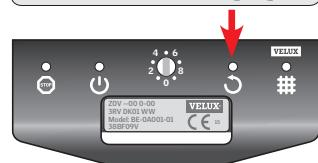
Als het filter is vervangen, drukt u de resetknop om de warmteterugwin-ventilatiemodule te resetten.
