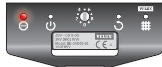
En caso de errores en la unidad de ventilación de recuperación de calor, el diodo emisor de luz roja se encenderá.
