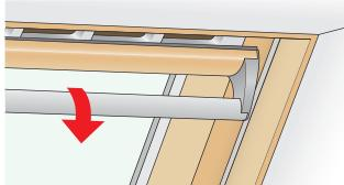
Når ventilationsklappen på ovenlysvinduet åbnes, starter det indbyggede ventilationssystem automatisk. Når ventilationsklappen lukkes, standser ventilationssystemet.
