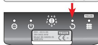
Når filteret er udskiftet, trykkes på resetknappen for at nulstille ventilationsenheden.
