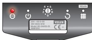
U slučaju pogreške na ventilaciji s rekuperacijom, uključuje se crvena svjetleća dioda. Za resetiranje ventilacije s rekuperacijom zatvorite i otvorite ventilacijski preklop.
