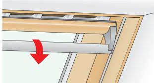
Wanneer u de ventilatieklep van het dakraam opent, zal het ventilatiesysteem automatisch worden geactiveerd. Bij het sluiten van de ventilatieklep schakelt het ventilatiesysteem uit.
