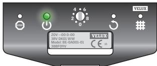
Lorsque la fonction ventilation est activée, la diode lumineuse verte clignote pendant 10 secondes.
