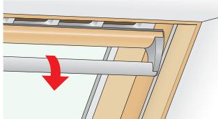
Le système de ventilation est activé automatiquement avec l'ouverture du clapet de ventilation de la fenêtre de toit. Le système se désactive lors de la fermeture du clapet.
