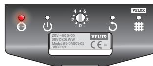
In caso di errori alla ventilazione forzata per il recupero del calore, il diodo luminoso rosso è acceso. Per resettare la ventilazione forzata per il recupero del calore, chiudi e apri l'aletta di ventilazione.
