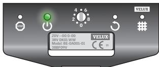
Cuando se activa la función de ventilación, el diodo emisor de luz verde parpadea on y off durante 10 segundos.
