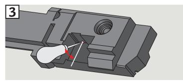
Faire un trou pour le passage du câble dans le bloc isolant avec un objet pointu dans la zone indiquée.
