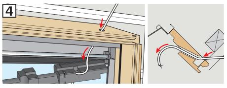
Passer le câble par le trou dans la partie haute du cadre fixe et au travers du bloc isolant.
