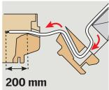
Passer le câble par le trou dans la partie haute du cadre fixe et au travers du trou de l'ouvrant. Retirer le cache plastique s'il y en a un. Couper le câble à longueur en laissant environ 200 mm de surplus.
