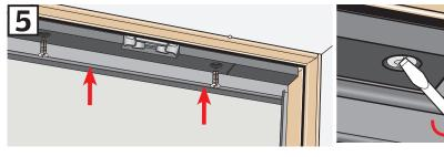
Remettre en place le bloc isolant.
