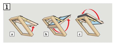
Ouvrir la fenêtre en utilisant la poignée a. Tirer la barre de manœuvre vers le bas b et retourner l'ouvrant de 180 degrés c.
