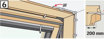
Passer le câble par le trou dans la partie haute du cadre fixe et au travers du trou de l'ouvrant. Retirer le cache plastique s'il y en a un. Couper le câble à longueur en laissant environ 200 mm de surplus. Placer une pastille de mastic sur le trou. Fixer le câble sur l'habillage.
