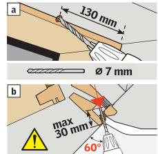
Percer un trou pour le câblage entre la partie haute du cadre fixe et l'habillage a .
