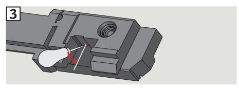
Faire un trou pour le passage du câble dans le bloc isolant avec un objet pointu dans la zone indiquée.
