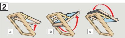
Ouvrir la fenêtre en utilisant la poignée a. Tirer la barre de manœuvre vers le bas b et retourner l'ouvrant de 180 degrés c.
