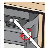
Retirer le bloc isolant en partie haute du cadre fixe avec un tournevis.
