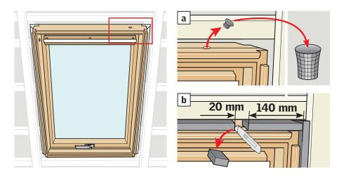
Ôter le cache plastique a. Si la collerette d'isolation du kit d'installation BDX est installée en périphérie de fenêtre, le bloc isolant doit être découpé à l'aplomb du cache b.
