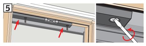
Remettre en place le bloc isolant.
