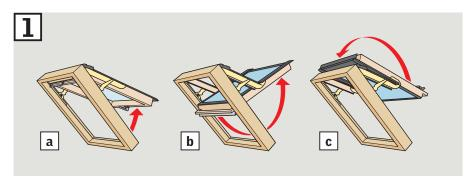
① Ouvrir la fenêtre en utilisant la poignée a. Tirer la barre de manœuvre vers le bas b et retourner l'ouvrant de 180 degrés c.
