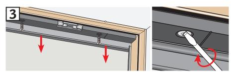
Retirer le bloc isolant en partie haute du cadre fixe avec un tournevis.
