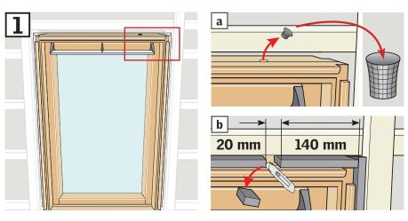
Ôter le cache plastique a. Si la collerette d'isolation du kit d'installation BDX est installée en périphérie de fenêtre, le bloc isolant doit être découpé à l'aplomb du cache b. Le bloc isolant découpé devra être remis en place après réalisation du câblage.
