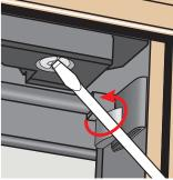
Remettre en place le bloc isolant. Tendre le câble pour éviter qu'il se coince entre le bloc isolant et la partie haute du cadre fixe.
