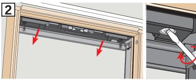
Retirer le bloc isolant en partie haute du cadre fixe avec un tournevis.
