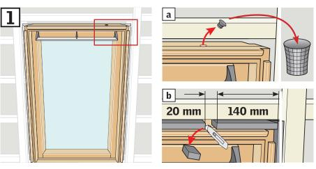
Ôter le cache plastique a. Si la collerette d'isolation du kit d'installation BDX est installée en périphérie de fenêtre, le bloc isolant doit être découpé à l'aplomb du cache b.
