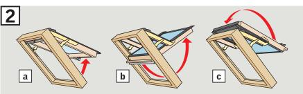
Ouvrir la fenêtre en utilisant la poignée a. Tirer la barre de manœuvre vers le bas b et retourner l'ouvrant de 180 degrés c.
