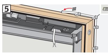
Tendre le câble pour éviter qu'il se coince entre le bloc isolant et la partie haute du cadre fixe. Placer une pastille de mastic sur le trou. Fixer le câble sur l'habillage.
