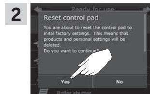
Na ekranu displeja, pritisnite "Da" da biste potvrdili da želite da resetujete upravljačku jedinicu.
