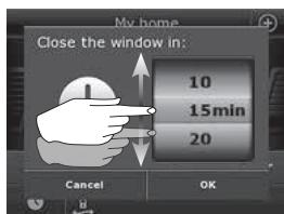
Vse izdelke upravljate s tapkanjem ikon/gumbov ali pomikanjem drsnika in tapkanjem vrstice na zaslolu. Izdelek, ki ga lahko upravljate, je prikazan na sredini zaslona. Če je v upravljalni tablici prijavljenih več izdelkov, so ti prikazani zatemnjeno ob straneh zaslona. Izdelek, ki ga želite upravljati, izberete tako, da podrsate s prstom po zaslolu v smeri puščic.
