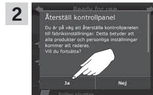
Tryck på "Ja" för att bekräfta att du vill återställa kontrollenheten. Kontrollenheten är nu återställd. För att använda kontrollenheten igen, se avsnitt *Startprocedur*.
