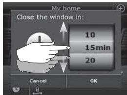
Tüm ürünler simgeler/düğmelere dokunularak ya da kaydırma çubuğu sürüklendiğinde ekranın yanlarında gösterilir. Produkterin ekranında gösterilmesi durumunda, ürünler ekranın yanlarında gölgelendirilmiş olarak gösterilir. Parmağınızı ekran üzerine okların yönünde hareket ettirerek istediğiniz ürünü seçin.
