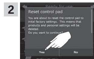
Dokunmatik kumanda panelini sıfırlamak istediğiniz onaylamak için "Evet" düğmesine dokunun.
