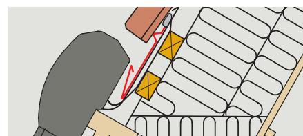
**NEDERLANDS:** Als het rolluik wordt geplaatst op een dakraam dat is ingebouwd met het gootstuk EDJ of EDN: Buig de afvoergoot naar beneden om ruimte te maken voor het rolluik.
