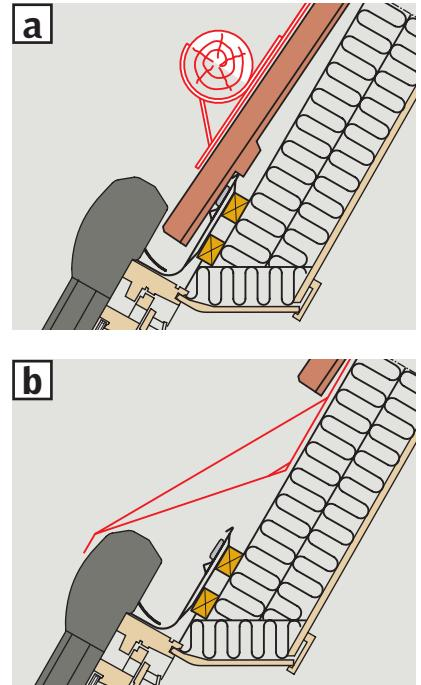
**DEUTSCH:** Zur Vermeidung von Schäden durch Schnee am Rollladen, die ortsübliche Baupraxis und die bekannten Regelwerke berücksichtigen. Beispiele von Schutzmaßnahmen: Schneefangnase **a**, Schneerechen **b**. Der Rolladenantrieb ist gegen Überlastung geschützt und setzt automatisch aus, falls er blockiert wird.
