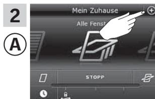
Führen Sie die Schritte 2-4 mit Bedienung (A) durch, um eine Kopie zu senden. Tippen Sie auf  $\oplus$ .
