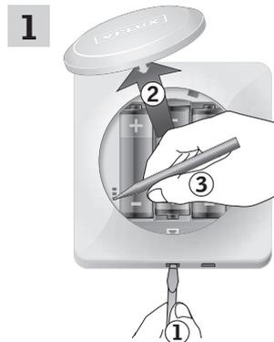
Lösen Sie den Batteriedeckel durch das Drücken des Druckknopfes mit einem Schraubendreher wie in der Abbildung gezeigt **(1)**, **(2)**.
