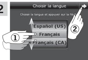
Choisir la langue. Tourner, en effleurant avec votre doigt, la roue affichée dans le sens des flèches ①.
