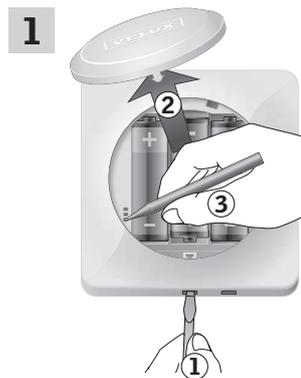
Rimuovere il coperchio delle batterie premendo il tasto con un cacciavite, come mostrato nell'illustrazione **1**, **2**.
