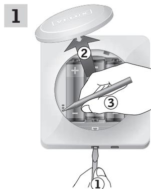
Uklonite poklopac odjeljka za baterije tako što ćete odvijačem pritisnuti gumb, kao što je prikazano na slici **1**, **2**.
