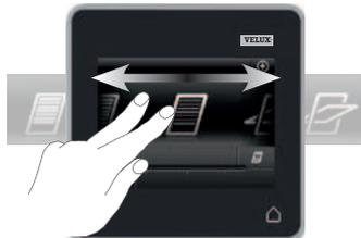
Svim proizvodima upravljate tako da dotaknete ikone/gumbe ili da pomičete klizač i dotaknete traku na zaslону.
