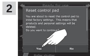
Dotaknite "Da" kako biste potvrdili da želite resetirati upravljački panel.
