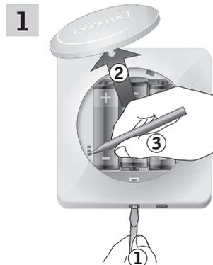
Quite la tapa de la batería presionando el orificio con un destornillador, tal como se muestra en la imagen **(1, 2)**.
