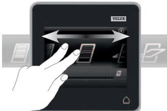
Управлявате всички продукти, като чуквате върху иконите/ бутоните или като дърпате плъзгача и чуквате върху лентата на дисплея.
