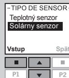
3 Položku "Solárny senzor" označíte pomocou navigačných tlačidiel .
