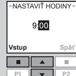
7 Pomocou navigačných tlačidiel si nastavíte hodinu. Nastavenie potvrďte stlačením tlačidla "Vstup".
