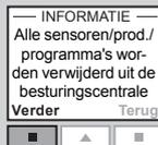
De besturingscentrale is nu gereset. Om de verbinding tussen besturingscentrale, zonweringproducten en sensoren te herstellen, kunt u het hoofdstuk *De initiële set-up* raadplegen.
