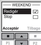
6 For at afbryde programmet VELUX ACTIVE i et bestemt tidsrum skal start- og sluttidspunkt indstilles.
