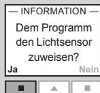
**6** Das Display zeigt den/die neuen Lichtsensor(-en). Drücken Sie **Nr. 2** um "Nr. 2" zu markieren. Drücken Sie **Enter**, um Ihre Auswahl zu bestätigen. Um die einzelnen Lichtsensoren zu identifizieren, siehe Abschnitt *Identifizierung von Sensoren*.
