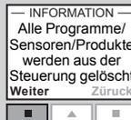
Die Steuerung wurde jetzt zurückgesetzt. Zur Wiederherstellung der Verbindung zwischen Steuerung, Sonnenschutzprodukten und Sensoren folgen Sie bitte den Anweisungen im Abschnitt *Erstinstallation*.
