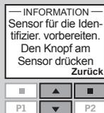
6 Das Display zeigt, dass der Sensor identifiziert wurde. Wenn die gezeigte Anzeige nicht erscheint, ist der entsprechende Lichtsensor nicht identifiziert worden. Wiederholen Sie Punkt 5, bis die Anzeige zeigt, dass der Sensor identifiziert worden ist.
