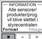
Styrecentralen er nu nulstillet. For at genetablere forbindelsen mellem styrecentral, solafskærmningsprodukter og sensorer skal instruktionerne i afsnittet *Startprocedure* følges.
