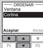
5 En la pantalla aparece una lista de productos del tipo elegido. Los productos pueden identificarse presionando brevemente **OK**. Esto activará brevemente el producto. Presione **Atrás** para seleccionar el producto.
