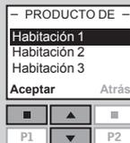
4 La pantalla muestra una lista de tipos de producto en la Habitación 1. Para seleccionar el tipo de producto motor de apertura del tragaluz, presione para seleccionar "Ventana". Presione "Aceptar" para confirmar.
