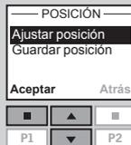
6 Presione para ajustar la posición de apertura del tragaluz. 100% corresponde a la apertura total. Presione "Aceptar" para confirmar.
