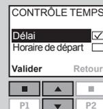
9 Appuyer sur pour régler le délai correspondant. Choisir d'abord les minutes. Choisir 0 minute si vous souhaitez l'ouverture immédiate du puits de lumière. Appuyer sur "Valider" pour régler ensuite les heures.
