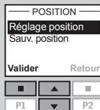
6 Appuyer sur pour régler la position d'ouverture du puits de lumière. 100% correspondant à l'ouverture complète. Appuyer sur "Valider" pour confirmer votre réglage.
