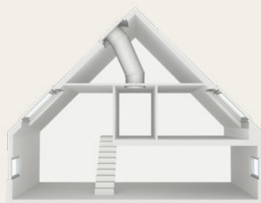
Gaismas tuneļis slīpam jumtam ar fiksētu cauruli
