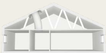
Gaismas tuneļis slīpam jumtam ar gofrētu cauruli
