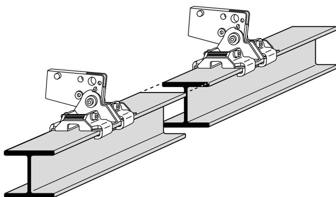
La connexion des profilés acier ne doit pas se faire au niveau des fixations.
