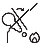
L'exutoire s'ouvre automatiquement en cas de détection de fumée pour permettre une évacuation rapide de la fumée et de la chaleur. L'exutoire répond aux exigences de la législation de l'UE. Les exutoires de fumée de toit VELUX peuvent également être ouverts pour laisser entrer l'air frais et assurer une ventilation aisée.
