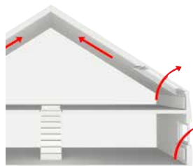
Dříve unikalo teplo i vlhkost.
