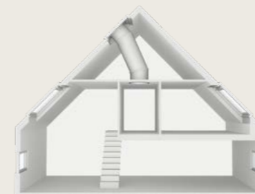
Sztywny świetlik tunelowy do dachów skośnych
