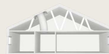
Elastyczny świetlik tunelowy do dachów skośnych
