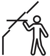
Les fenêtres de toit à rotation permettent de placer des meubles directement sous la fenêtre sans gêner son fonctionnement. Nous recommandons une hauteur d'installation permettant une vue dégagée vers l'extérieur, à la fois en position debout et assise. Veuillez noter que la hauteur optimale de la fenêtre dépend de l'inclinaison du toit.
