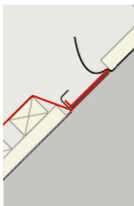
Nun wird das überschüssige Material der Anschlusschürze in den Wasserlauf der Wasserableitrinne gelegt.
