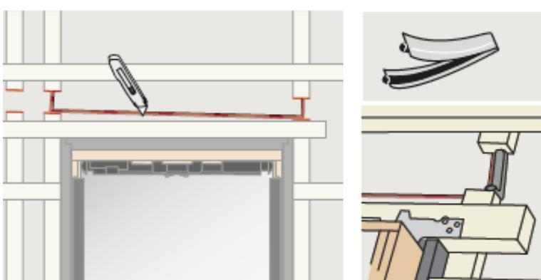
Die Unterspannbahn im Bereich der Wasserableitrinne durchschneiden.
