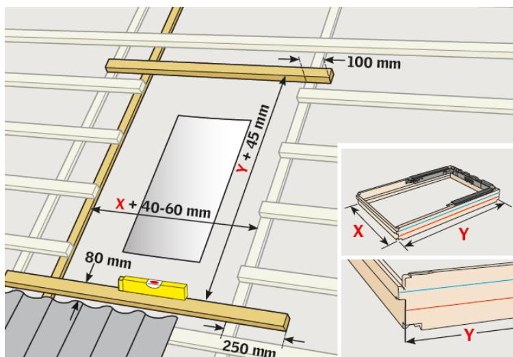
Dachausschnitt, wie in der Einbauanleitung des Dachfensters bzw. Eindeckrahmens beschrieben, vorbereiten.
