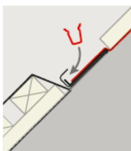
Anschlusschürze und Unterspannbahn mit Hilfe der beiliegenden Montageklippe befestigen.
