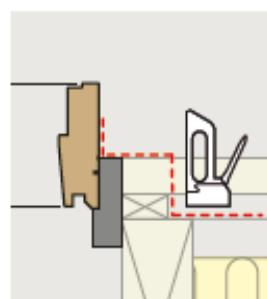
Lattungsseitig wird die Anschlusssschürze mit den Dachlatten sicher verbunden z.B. durch tackern.
