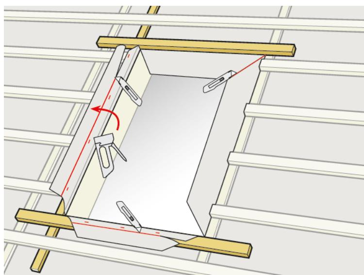
Die Unterspannbahn im Trapez- oder Kreuzschnitt aufschneiden.
