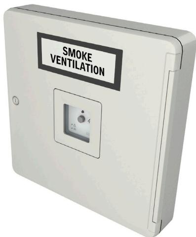
Med styreenheten KFC 220 kan du styre opptil 8 GGL/GGU-røykventilasjons vinduer samtidig eller 2 CSP-røykventilasjons vinduer for flate tak. Du kan enkelt åpne og lukke tilkoblede vinduer for å slippe inn frisk luft, ved hjelp av knappene på styrepanelet. KFC 220 har i tillegg integrert brannknapp og et reservebatteri med 72 timers driftstid, for ekstra sikkerhet.
