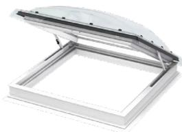
La finestra di uscita per tetti piani ad azionamento manuale CXP offre una maggiore apertura per fornire un facile accesso al tetto. Il vetro interno stratificato ne impedisce la frantumazione in caso di rottura. Disponibile con un cupolino in acrilico e policarbonato. La finestra di uscita per tetti piani è conforme alle normative UE applicabili.
