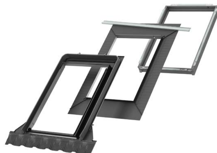
EDW 2000 burkolókeret BDX hőszigetelő kerettel a jobb energiahatékonyság érdekében
