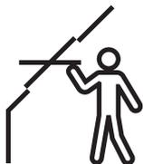
Les fenêtres de toit à ouverture par rotation par le haut permettent de placer les meubles directement sous la fenêtre sans gêner le fonctionnement de la fenêtre. Nous recommandons une hauteur d'installation offrant une ligne de vue dégagée vers l'extérieur, à la fois en position debout et assise. Veuillez noter que la hauteur optimale de la fenêtre dépend de l'inclinaison du toit.
