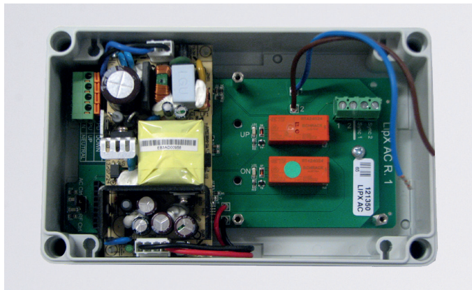
Flex1 ACDC som forsyning til motorer med egen overlastbeskyttelse. (Kæde- & tandstangsmotorer). Boks str. (LxBxH): 180 x 110 x 63 mm.
