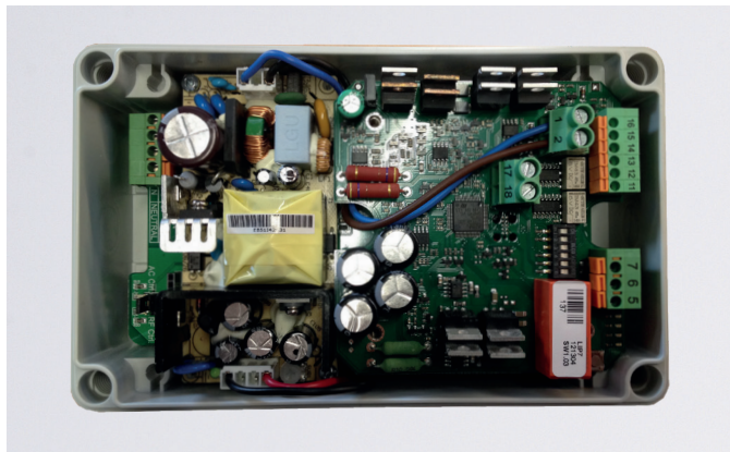
Flex1 ACDC som forsyning til indbygget overlastbeskyttelse f.eks. LIP7 OC #5443, Boks str. (LxBxH): 180 x 110 x 63 mm.
