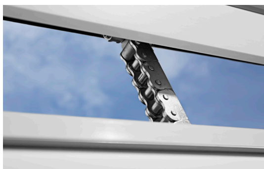
La chaîne dans l'actionneur caché soulève le module ouvrant pour la ventilation de confort ou l'évacuation de la fumée.
