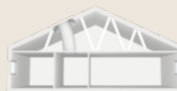
Flexibilis csöves fénycsatorna magastetőbe
