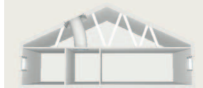
Flexibilis csöves fénycsatorna magastetőbe
