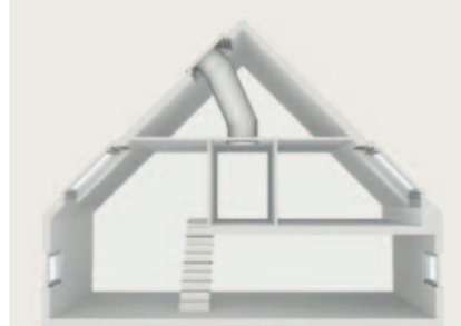
Merev csöves fénycsatorna magastetőbe
