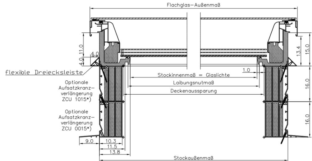
\*) Optional Aufsatzkranzverlängerung möglich. Insgesamt können bis zu 4 ZCU (1 x ZCU 0015 und 3 x ZCU 1015) mit dem CFU verbunden werden.
