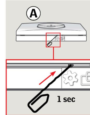
1.Vous devez confectionner un crochet rigide (fil électrique rigide 2,5mm<sup>2</sup> ,crochet d'ardoise , cintre métallique, gros trombone ,etc ) , Repérez la position du récepteur de chaîne. Par exemple une fenêtre de largeur M : 39 cm à gauche du bord de la barre.
