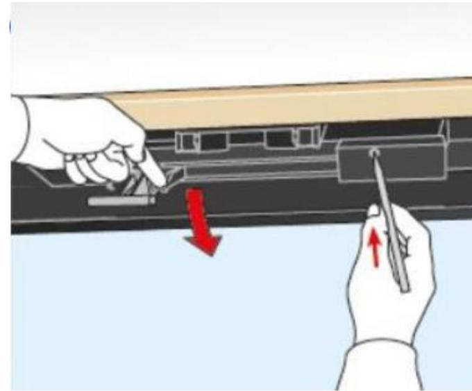
Après l'appui sur le bouton gris , le moteur d'ouverture fait des va-et-vient , s'il y a d'autres équipements (volet ,store ) ils vont aussi faire des va-et-vient (dans le désordre ).
