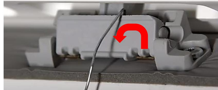
2.4 Poussez le clapet pour soulager la pression de réception de chaîne
