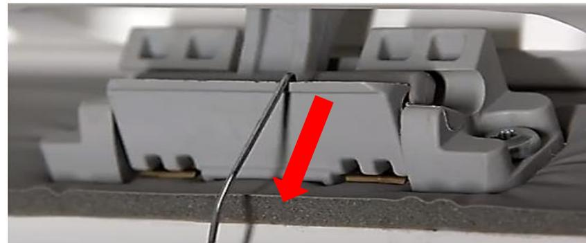
3. Appuyez 1 sec sur le bouton gris en sous-face du moteur (la chaîne rentre totalement , cela permet la manœuvre manuelle de l'ouvrant sans difficulté) ET ensuite de réinitialiser le moteur.
