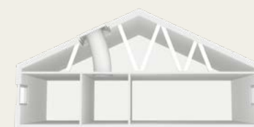
Savittljivi svjetlosni tunel na kosom krovu
