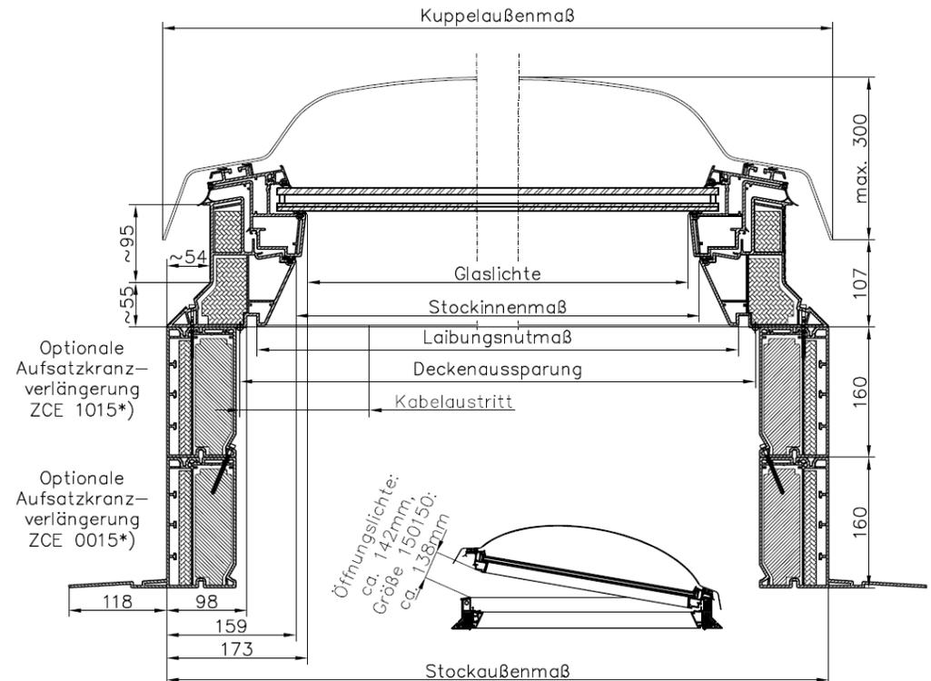
\*) Optionale Aufsatzkranzverlängerung ZCE S000 bestehend aus ZCE 0015 (mit Flansch) und 1015 (ohne Flansch), ergibt mit dem Fenster eine Gesamthöhe von ca. 45cm. Insgesamt können bis zu 4 ZCE (1 x ZCE 0015 und 3 x ZCE 1015) mit dem CVP verbunden werden.
