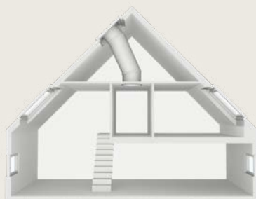
Твърд светлинен тунел за скатен покрив
