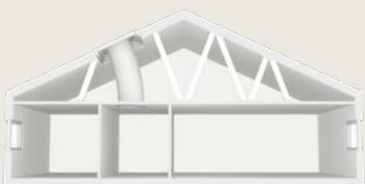
Гъвкав светлинен тунел за скатен покрив
