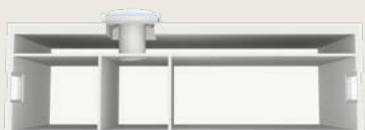
Светлинен тунел с твърда или гъвкава тръба за плосък покрив
