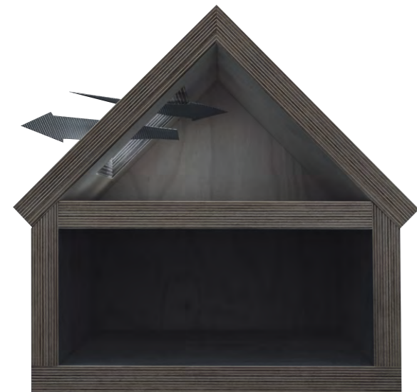
Öffnen der Fenster über die Nacht, sorgt für Abkühlung der Bauteile und frische Luft.
