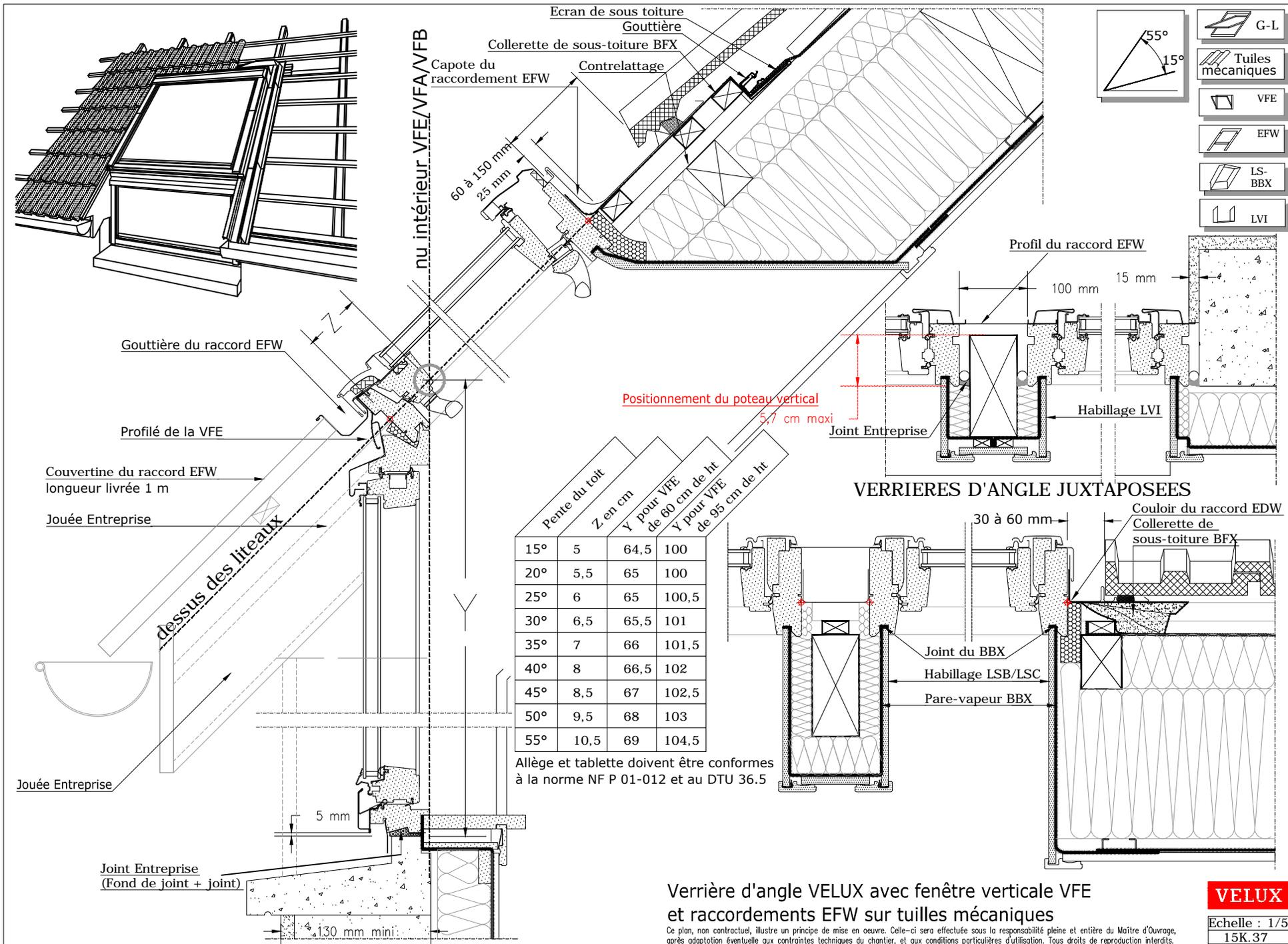
Verrière d'angle VELUX avec fenêtre verticale VFE et raccordements EFW sur tuiles mécaniques
