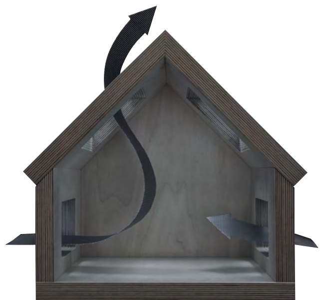
Durch Nutzung des Kamineffekts kann die Abkühlung über die Nacht beschleunigt und optimiert werden.
