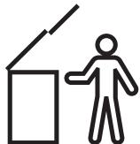
Das Zusatzelement VFA "FASSADE" wird vertikal direkt unter einem VELUX Dachfenster eingebaut, um mehr Tageslicht hereinzulassen und eine bessere Sicht zu gewährleisten. Das Fensterelement ist ein Drehkipfenster mit Linksaufhängung. Es wird mit einem Griff am rechten Flügel-Seitenteil bedient und kann als Notausstieg genutzt werden.
