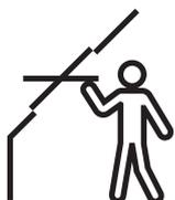
Le finestre con apertura a bilico manuale consentono di posizionare i mobili direttamente sotto la finestra senza ostacolare il funzionamento della stessa. Raccomandiamo un'altezza di montaggio che consenta una vista chiara verso l'esterno sia dalla posizione eretta che da quella seduta. L'altezza ottimale della finestra dipende dalla pendenza del tetto.
