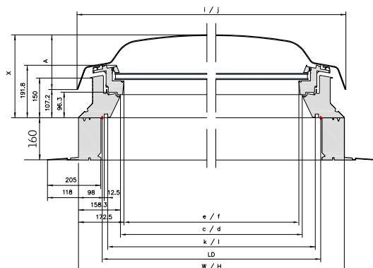
Fenêtre pour toit plat EFC CSP avec une costière fixe et une costière supplémentaire Purenit
