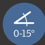
Toits plats et en pente de 0° à 15° (pente minimale recommandée pour le produit 3°)
