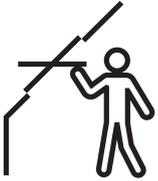
Schwingflügel Fenster mit manueller, oberliegender Bedienung bieten die Möglichkeit, Möbel direkt unter dem Fenster zu platzieren, ohne die Bedienung des Fensters zu behindern. Wir empfehlen eine Einbauhöhe, die sowohl in stehender als auch in sitzender Position eine klare Sicht nach aussen ermöglicht. Bitte beachten Sie, dass die optimale Fensterhöhe von der Dachneigung abhängt.
