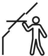
Les fenêtres de toit à rotation permettent de placer des meubles directement sous la fenêtre sans gêner son fonctionnement. Nous recommandons une hauteur d'installation permettant une vue dégagée vers l'extérieur, à la fois en position debout et assise. Veuillez noter que la hauteur optimale de la fenêtre dépend de l'inclinaison du toit.
