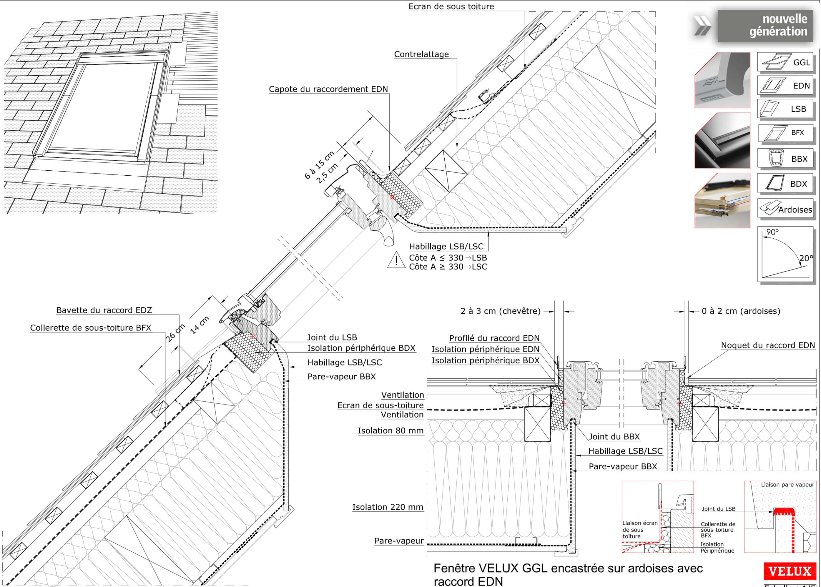
**Fenêtre VELUX GGL encastrée sur ardoises avec raccord EDN**
