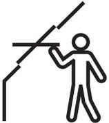
Manuelle Schwingfenster mit Oberbedienung bieten die Möglichkeit, Möbel direkt unter dem Fenster zu platzieren, ohne die Bedienung des Fensters zu beeinträchtigen. Wir empfehlen eine Einbauhöhe, die sowohl in stehender als auch in sitzender Position eine klare Sicht nach außen ermöglicht. Bitte beachten Sie, dass die optimale Fensterhöhe von der Dachneigung abhängt.
