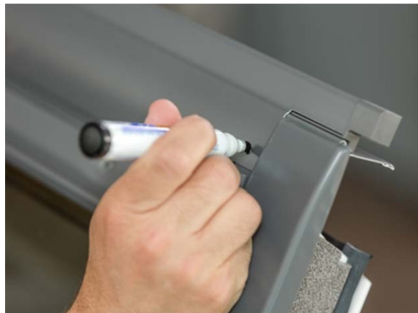
Marquer l'emplacement des trous avec le marqueur.
