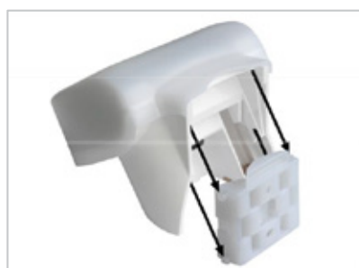
6.4.2.b Sensoren skubbes nedover den monterede holdeanordning, så holderens tapper låser i kassens skinner.
