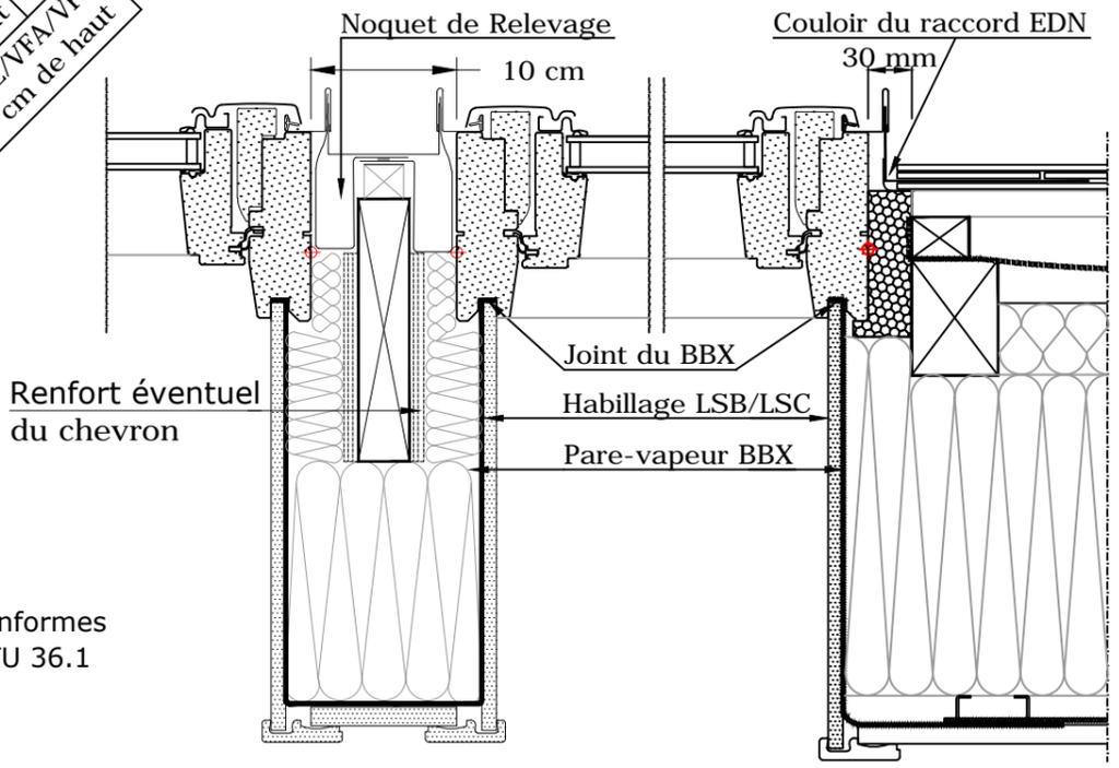
**Verrière d'angle VELUX avec fenêtre verticale VFE/VFA/VFB et raccords EFN sur ardoises**
