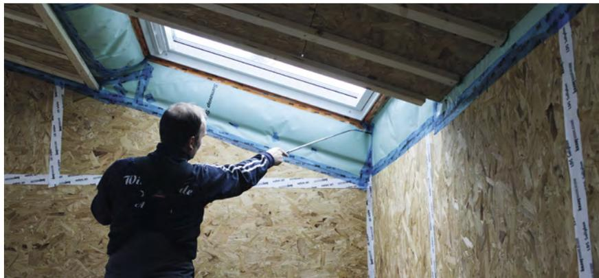
Aufspüren von Leckagen mit einem Luftgeschwindigkeitsmessgerät während der Blower-Door-Messung
