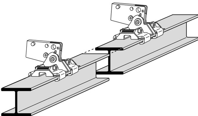
Verbindungsstöße der Stahlprofile dürfen nicht an jenen Stellen vorkommen, an denen später die Montagefüße der Module mit den Klammern befestigt werden.
