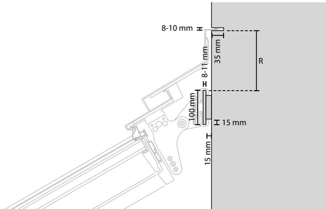
Stahl-, Beton- oder Holz-Unterkonstruktion mit Flachstahl
