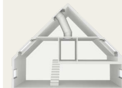
Šviesos tunelis standžiu vamzdžiu šlaitiniam stogui
