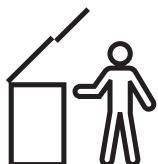
Das Zusatzelement VFV "FASSADE" wird vertikal direkt unter einem VELUX Dachfenster eingebaut, um mehr Tageslicht hereinzulassen und eine bessere Sicht zu gewährleisten. Das Fensterelement ist ein Drehkippenfenster mit Rechtsaufhängung. Es wird mit einem Griff am linken Flügel-Seitenteil bedient und kann als Notausstieg genutzt werden.
