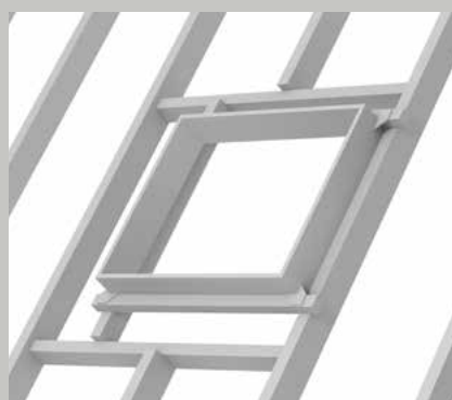
Výměna umožňuje použít střešní okno větší velikosti.
