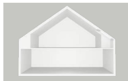
Řešení s přízdívkou a nikou pro střešní okno
