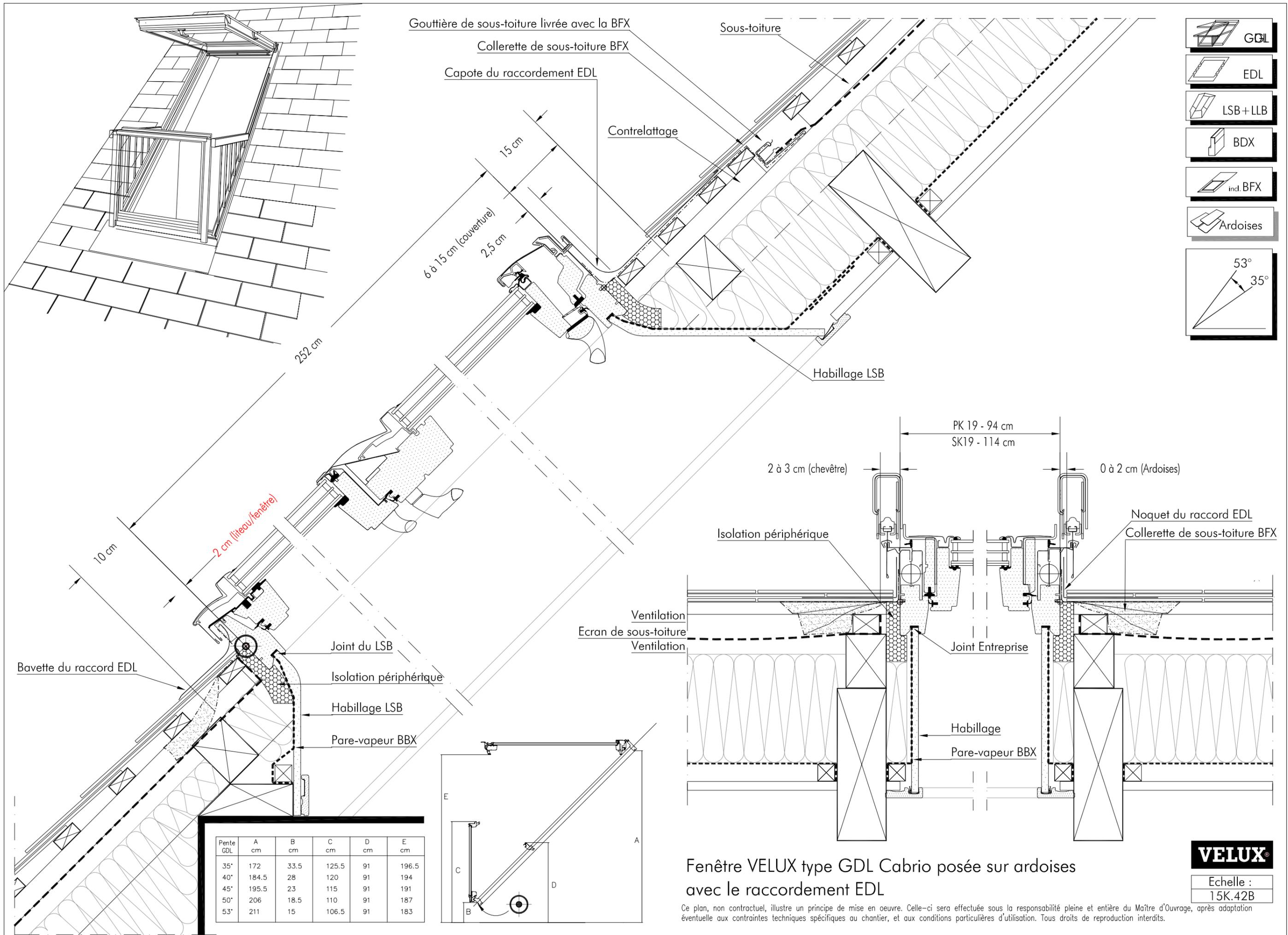
Gouttière de sous-toiture livrée avec la BFX
